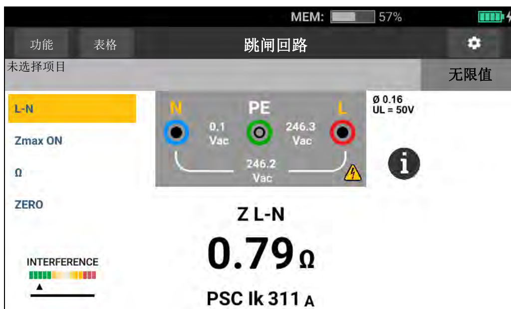
图 13. 线路阻抗测量屏幕
